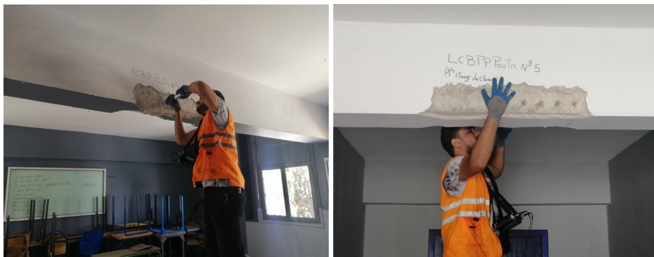
Figure 122, 123, 124, 125 et 126 : Essai d'auscultation sclérométrique.
