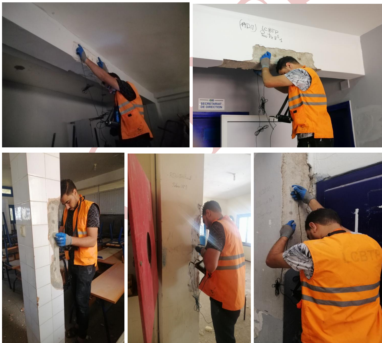
Figure 117, 118, 119, 120 et 121 : Essai d'auscultation sonique.
