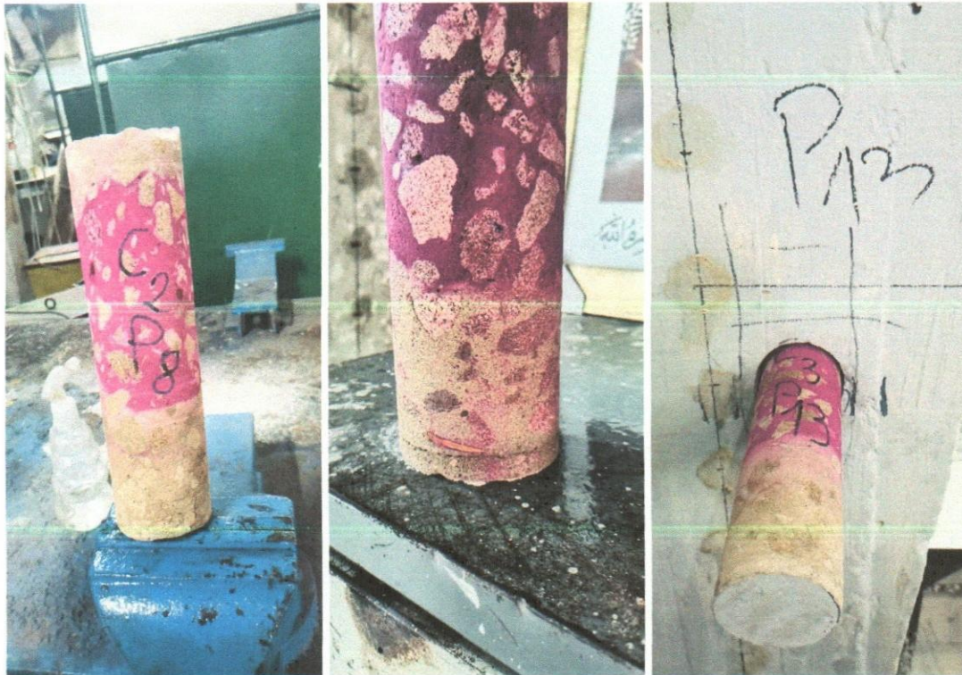
Carbonatation réalisée sur carottes prélevées
