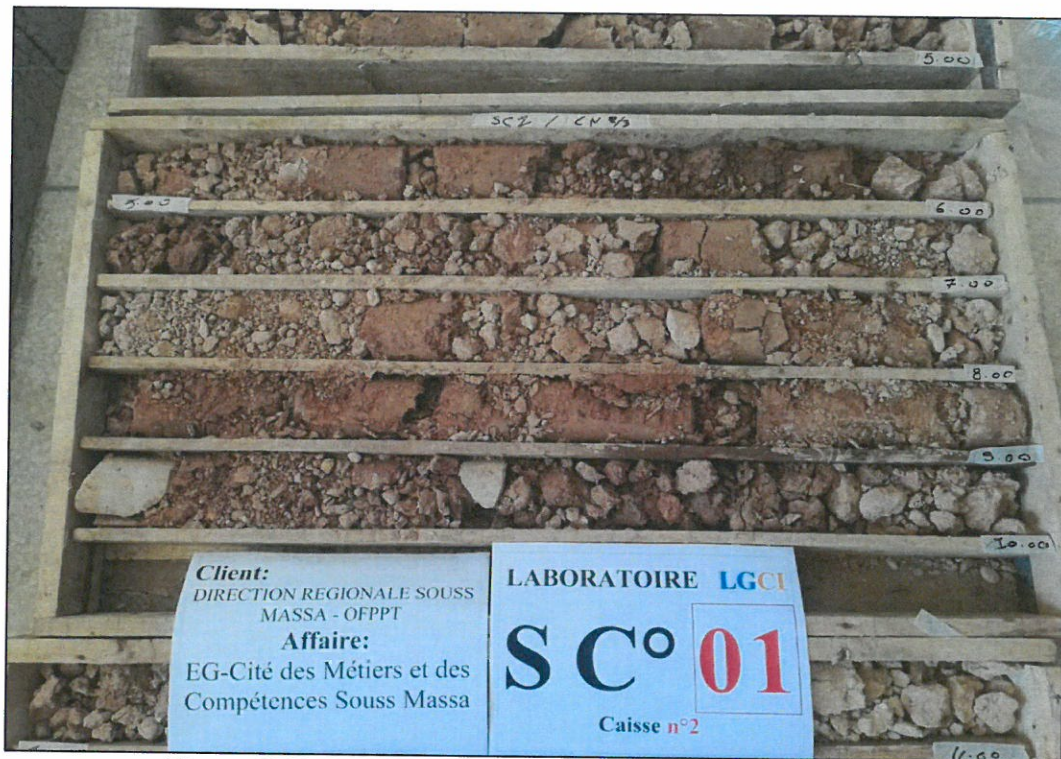
Photo N°3: Sondage carotté n°1 - De 6 à 10 m
