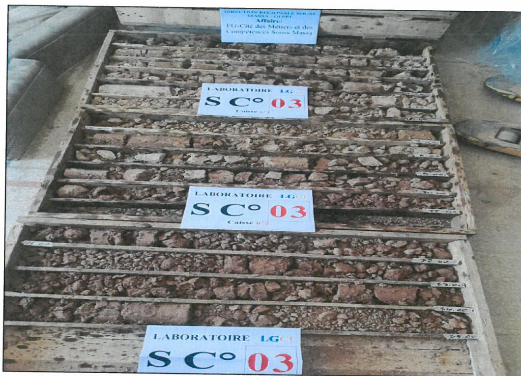
Photo N°9 : Sondage carotté n°3 – Sondage complet
