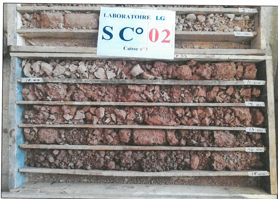
Photo N°8: Sondage carotté n°2 - De 11 à 15 m
