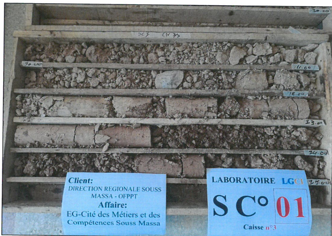
Photo N°4: Sondage carotté n°1 - De 11 à 15 m
