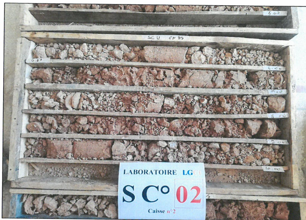
Photo N°7: Sondage carotté n°2 - De 6 à 10 m
