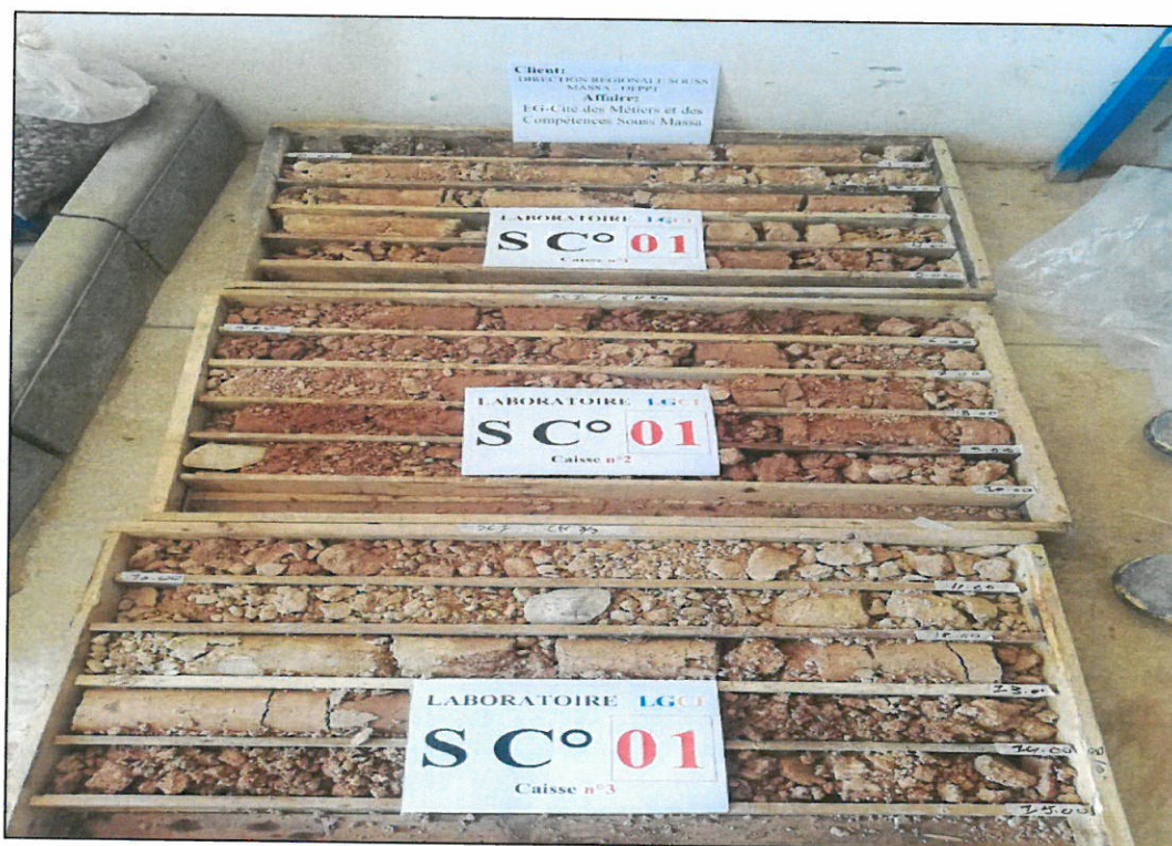
Photo N°1 : Sondage carotté n°1 – Sondage complet
