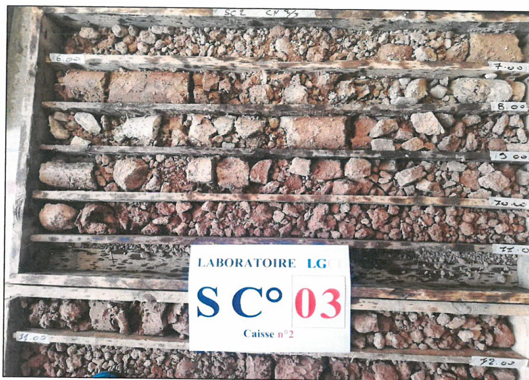
Photo N°11: Sondage carotté n°3 - De 7 à 11 m
