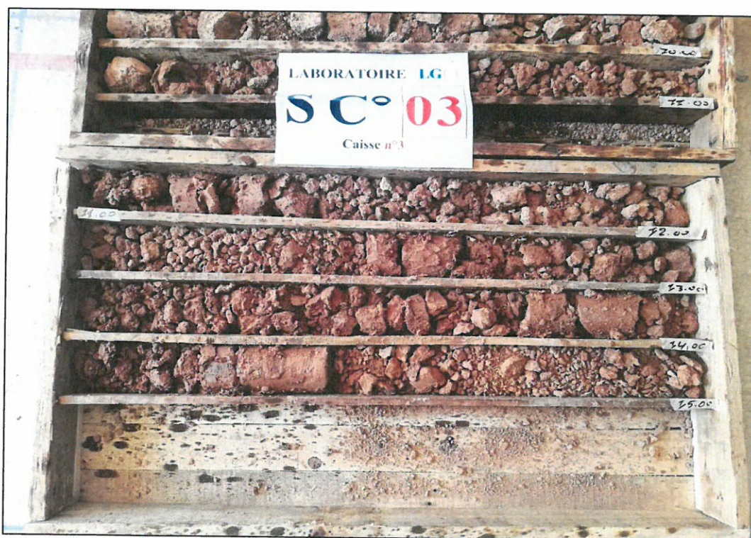
Photo N°12: Sondage carotté n°3 - De 12 à 15 m
