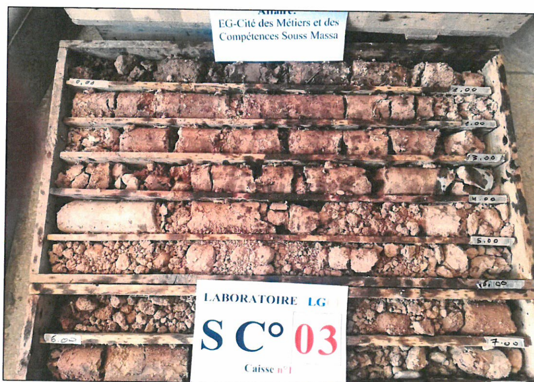
Photo N°10 : Sondage carotté n°3 – De 1 à 6 m
