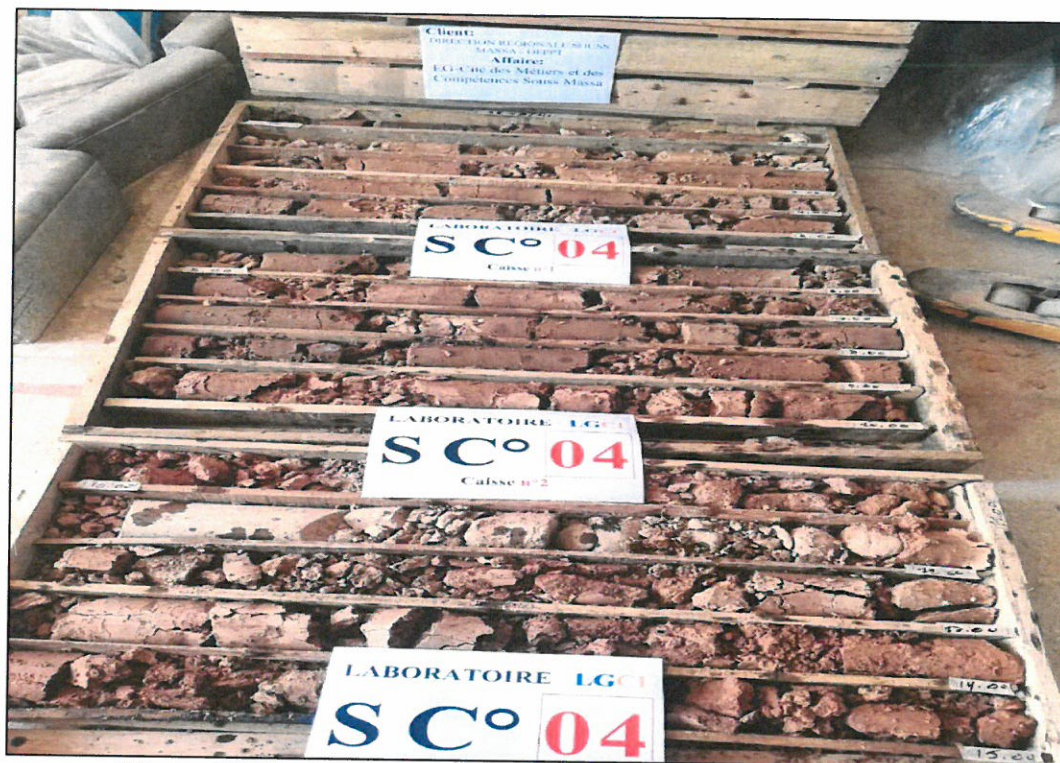
Photo N°13 : Sondage carotté n°4 - Sondage complet
