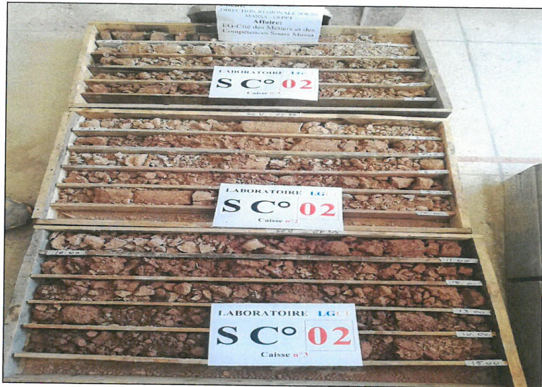
Photo N°5 : Sondage carotté n°2 – Sondage complet
