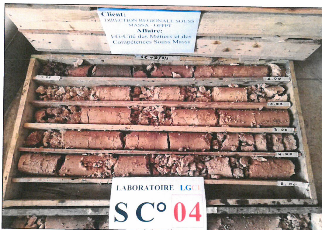
Photo N°14 : Sondage carotté n°4 - De 1 à 5 m
