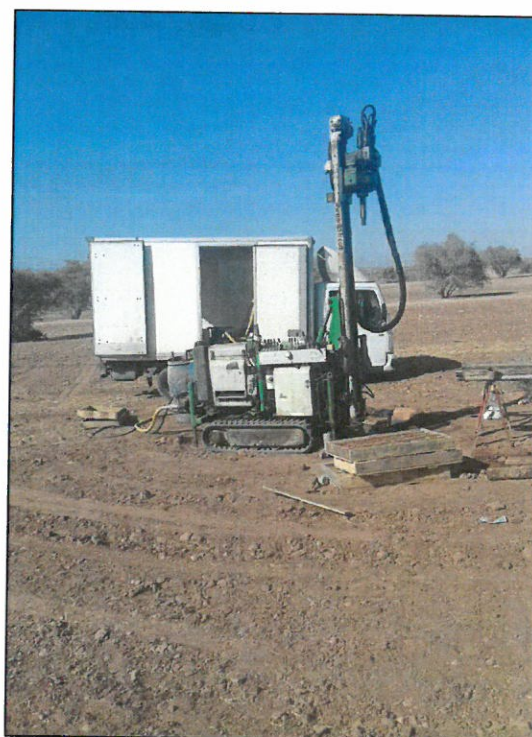
Photo N°20: Exécution des sondages carottés
