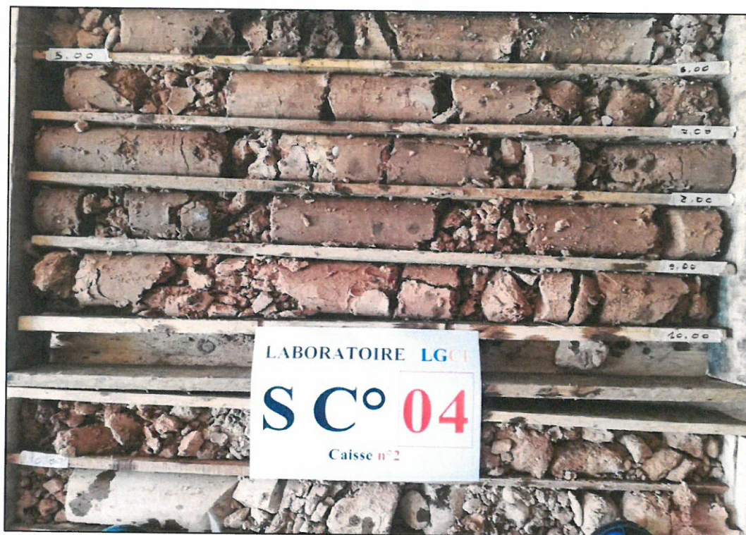
Photo N°15: Sondage carotté n°4 – De 6 à 10 m
