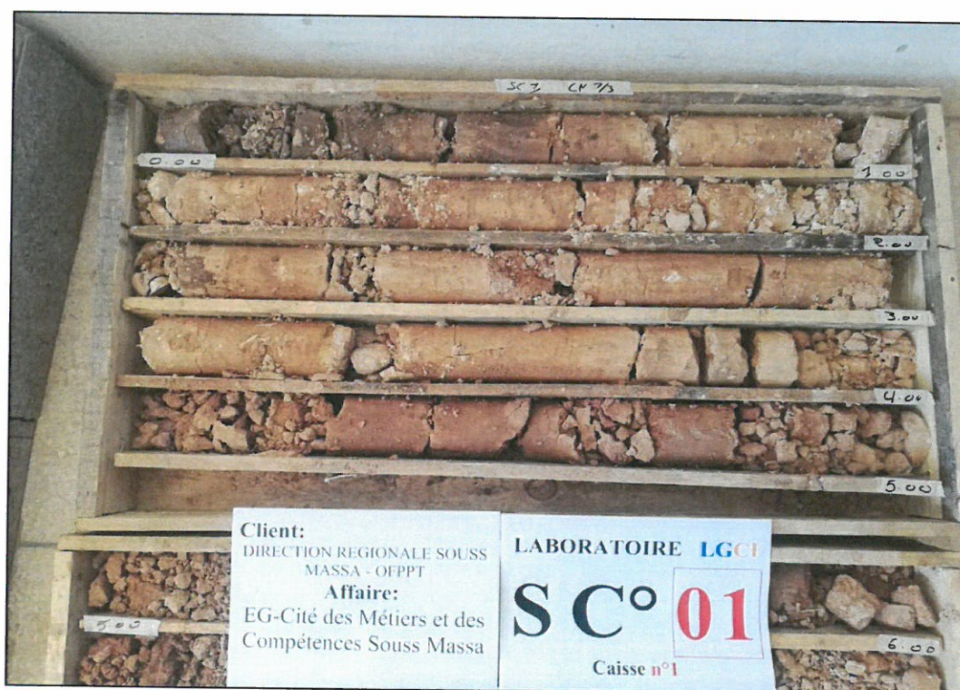
Photo N°2 : Sondage carotté n°1 – De 1 à 5 m
