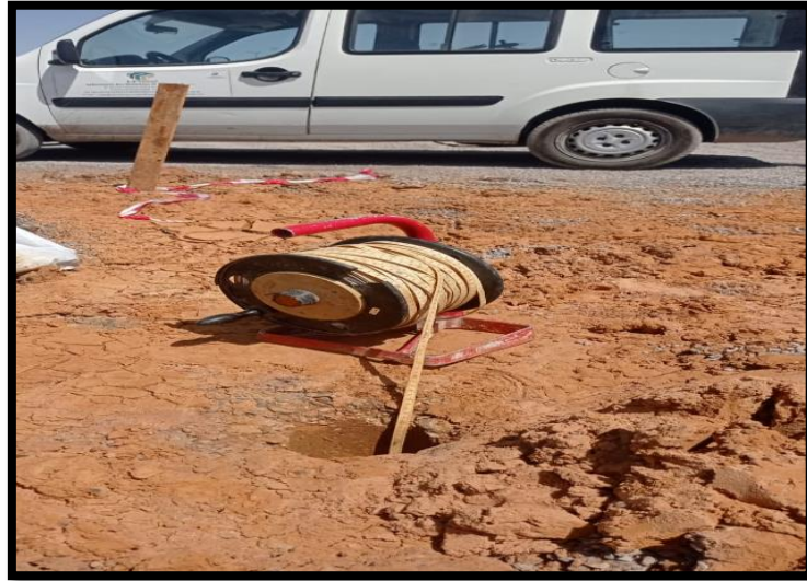
Photo N° 6 : Mesure piézométrique
