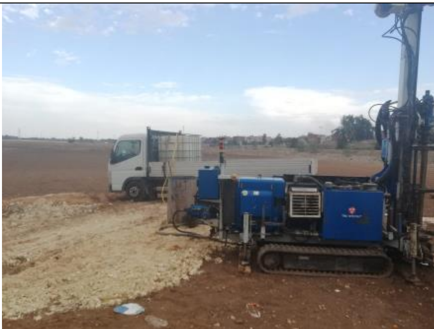
Photo n°17 : Réalisation des sondages carottés
