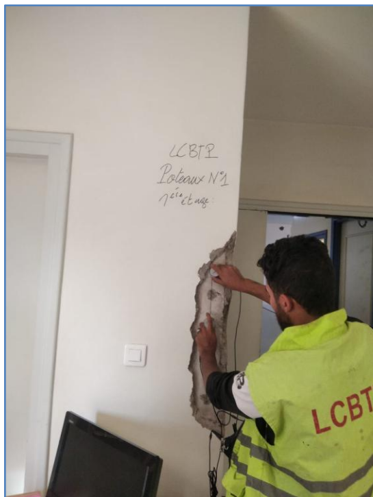
Figure 8 : Photos illustrant la réalisation de l'essai de l'auscultation sonique
