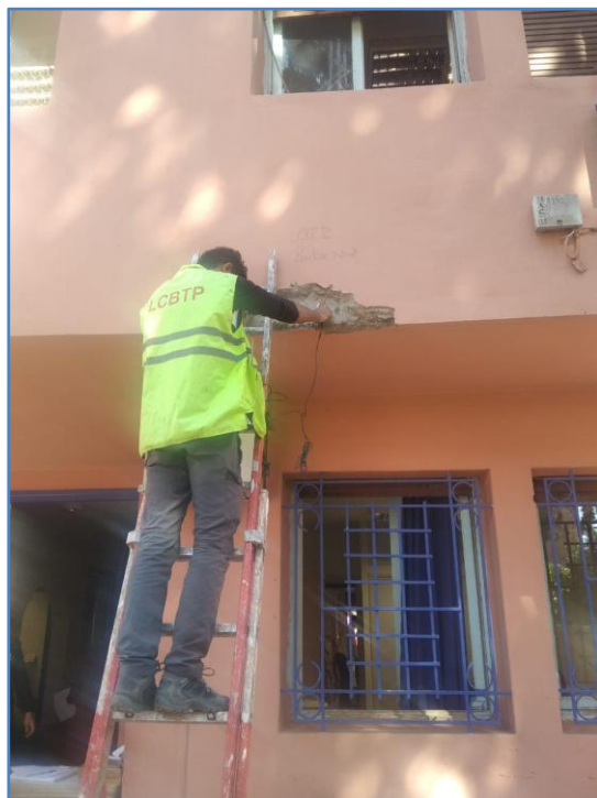
Figure 8 : Photos illustrant la réalisation de l'essai de l'auscultation sonique
