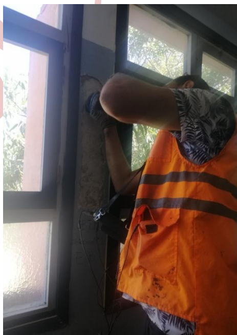
Figure 48 : Essai d'auscultation sonique.
