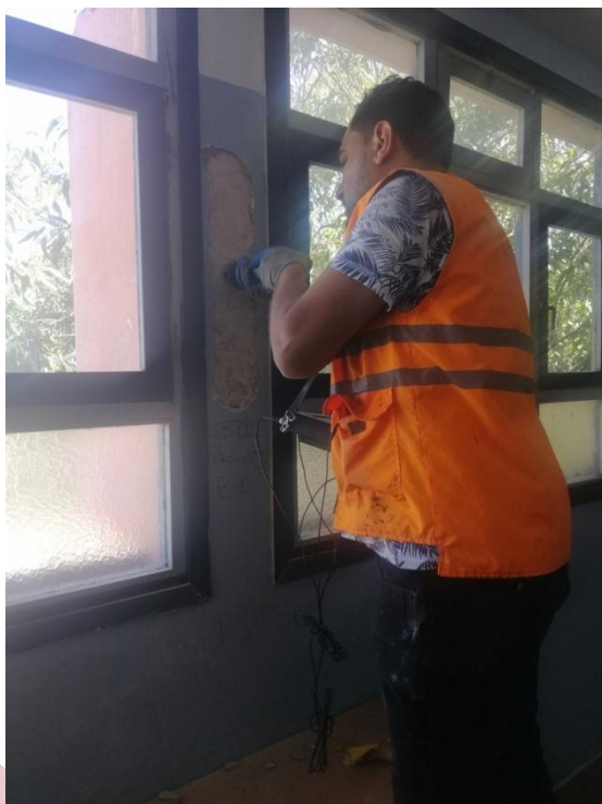
Figure 49 : Essai d'auscultation sclérométrique.
