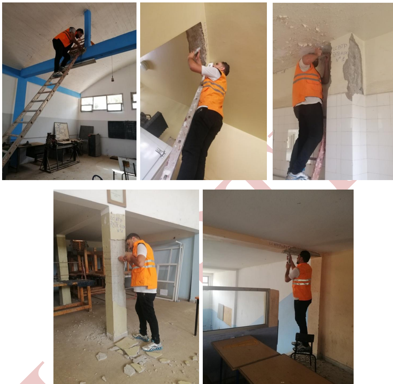
Figure 56, 57, 58, 59 et 60 : Essai d'auscultation sclérométrique.
