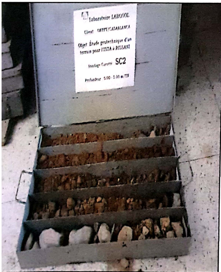
Photo N°7 et 8 : Montrant les matériaux extrais du sondage carotté SC2
