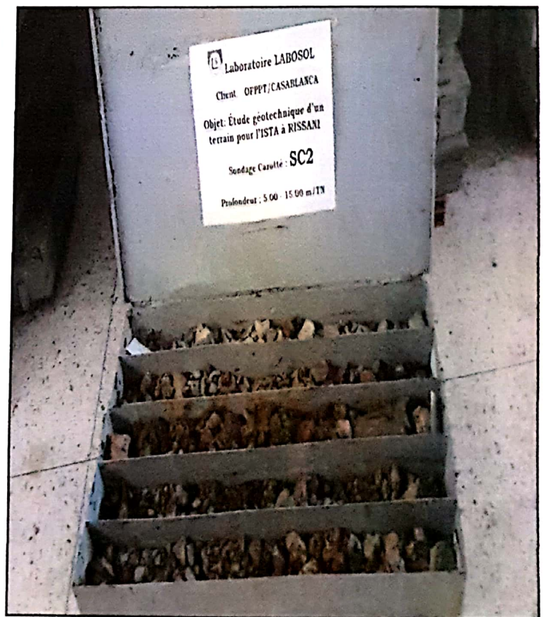
Photo N°7 et 8 : Montrant les matériaux extrais du sondage carotté SC2
