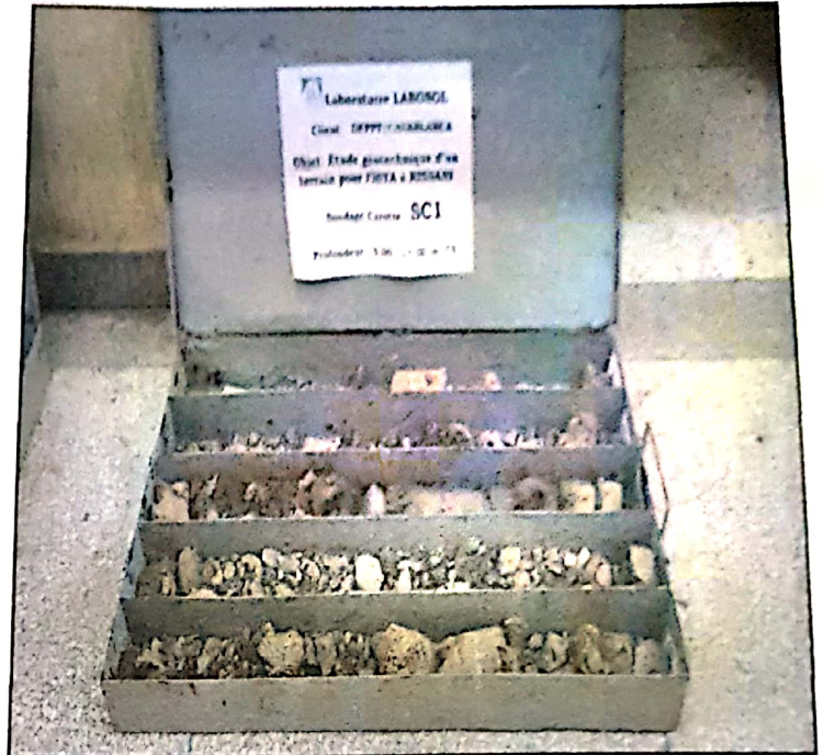
Photo N°7 et 8 : Montrant les matériaux extrais du sondage carotté SC1
