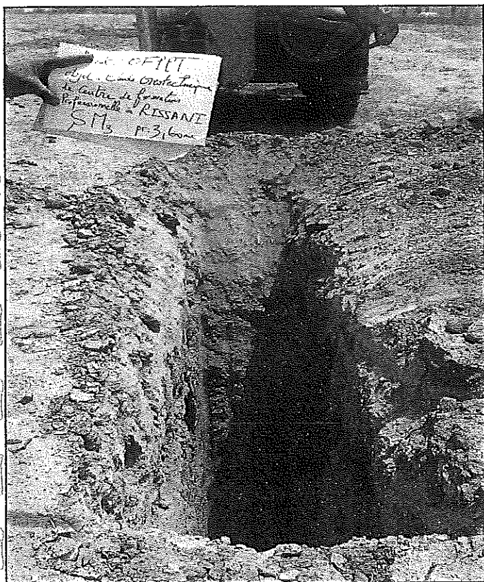
Photo N°3: Montrant le sondage manuel SM3
