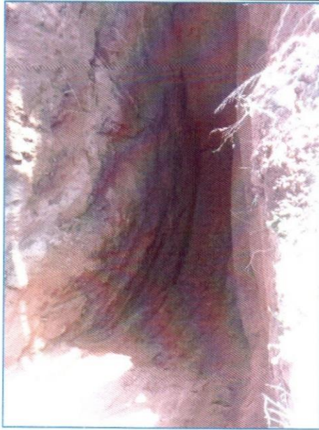
Photo N°3 : Sondage S3 montrant l'existence du sable argileux rougeâtre en profondeur
