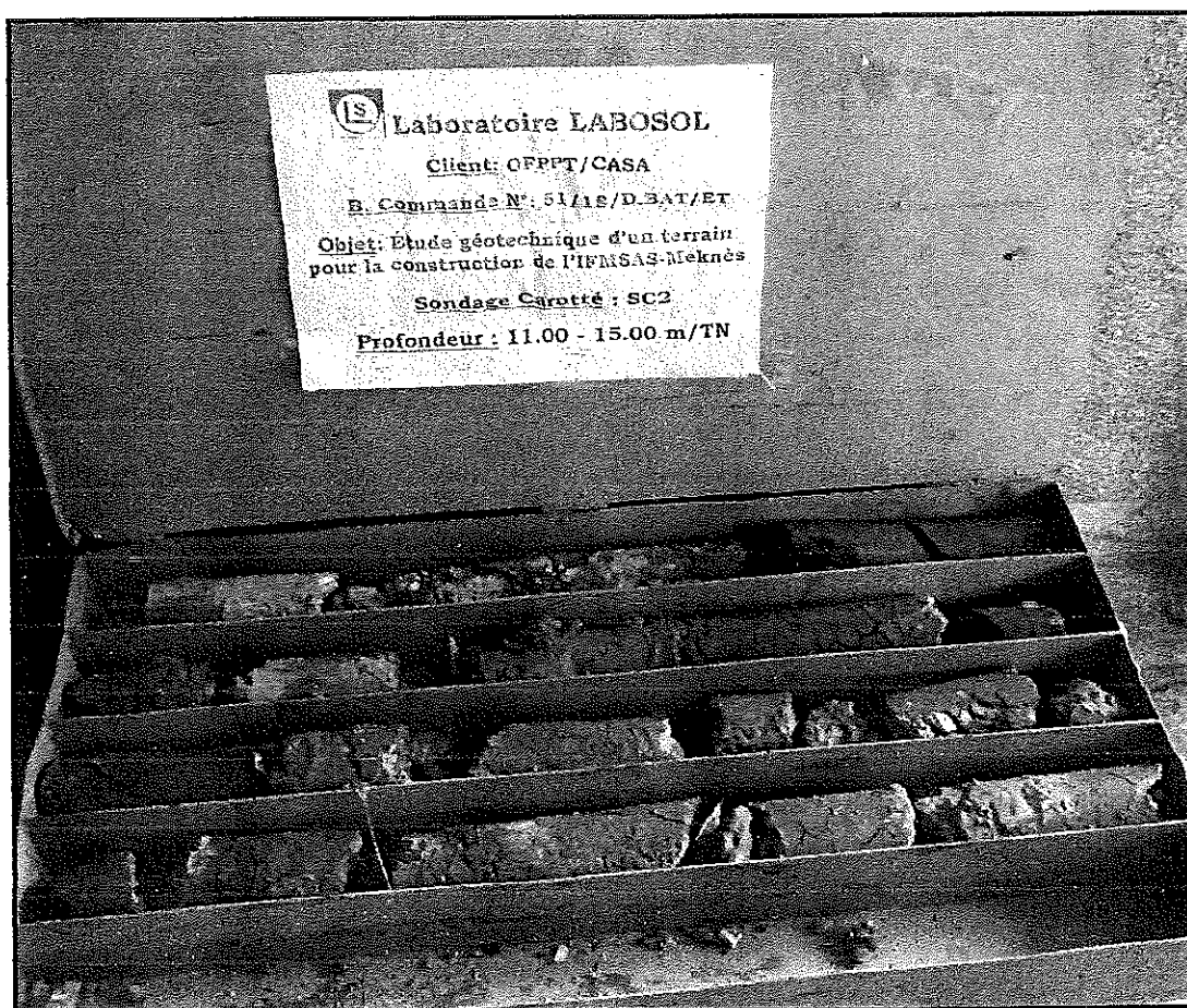
Photo N°3: Caisse Métallique montrant les matériaux extraits des sondages carotté SC1 et SC2
