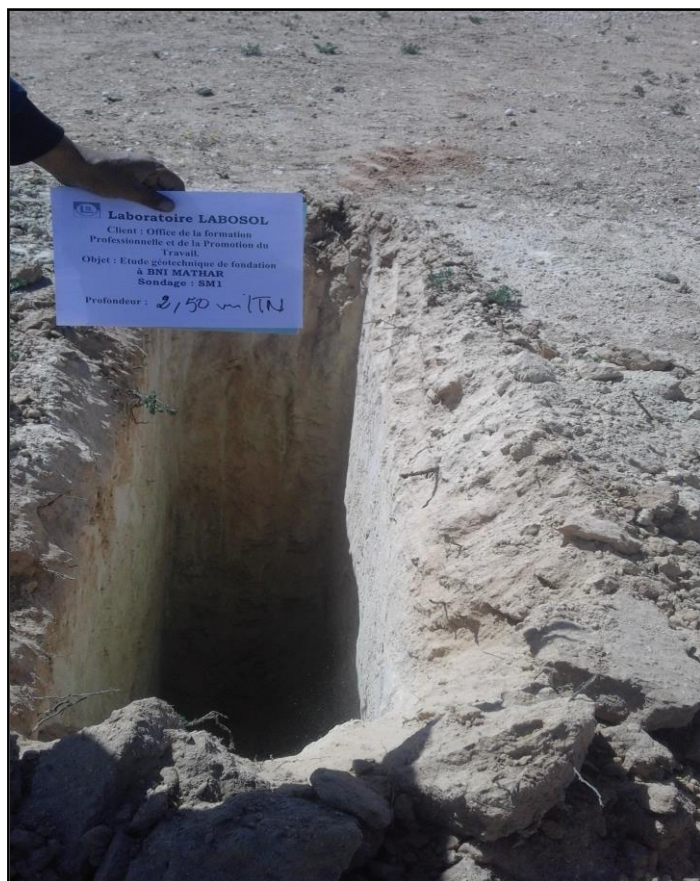
Photo N°1: Montrant le sondage manuel SM1
