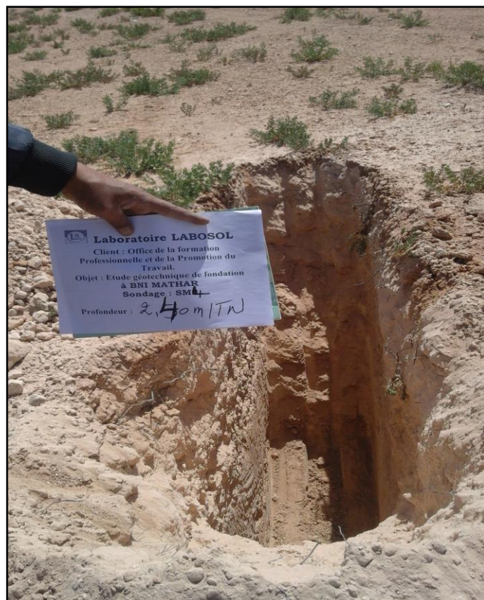
Photo N°4: Montrant le sondage manuel SM4
