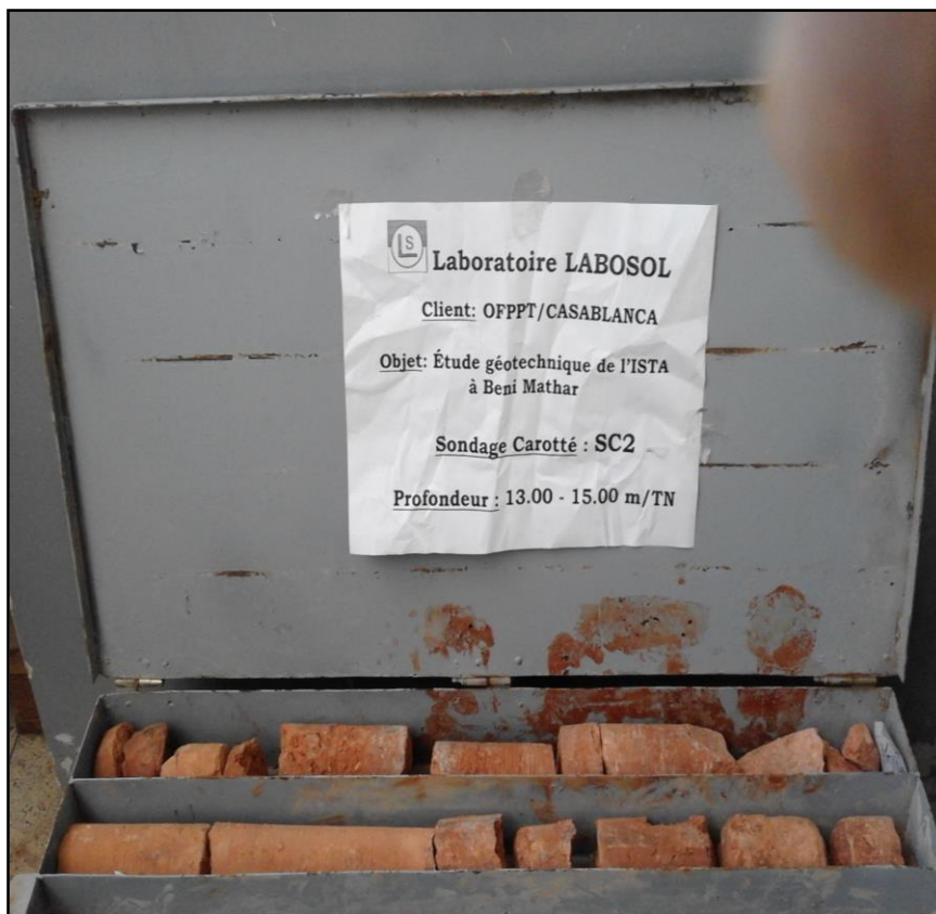
Photo N° 13 : Montrant les matériaux extrais du sondage carotté SC2
