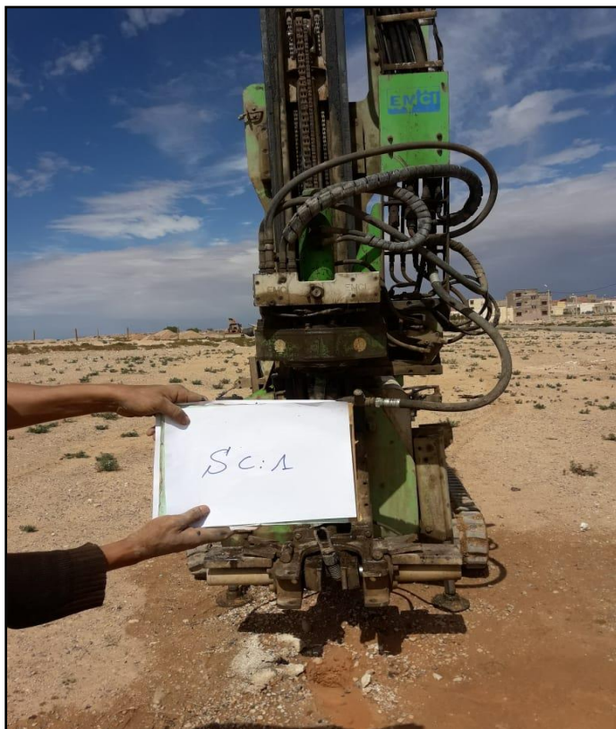
Photo N° 5 et 6: Montrant l'exécution du sondage carotté SC1
