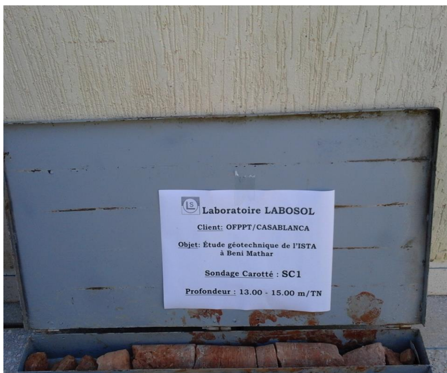
Photo N° 11 : Montrant les matériaux extrais du sondage carotté SC1
