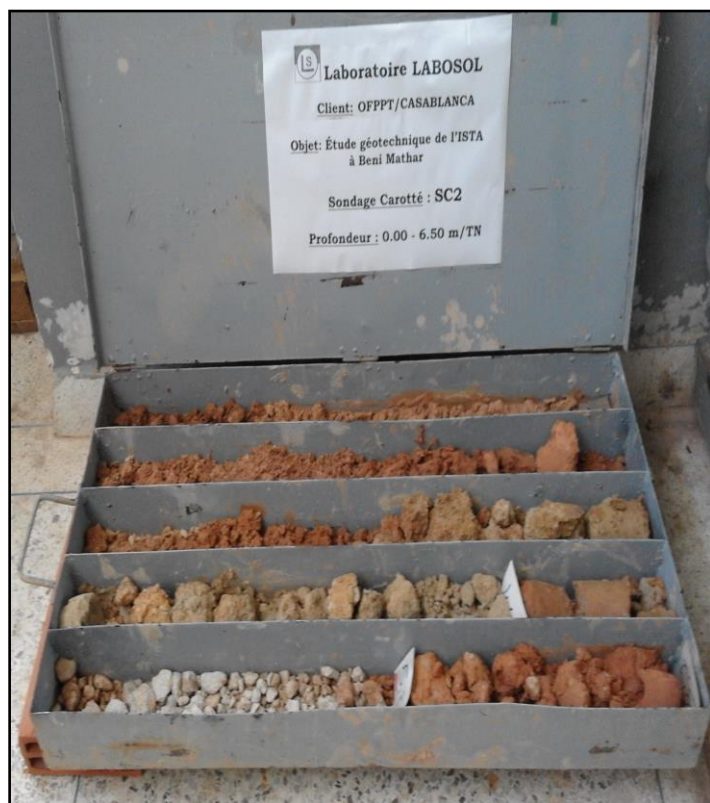
Photo N° 12 et 13 : Montrant les matériaux extrais du sondage carotté SC2
