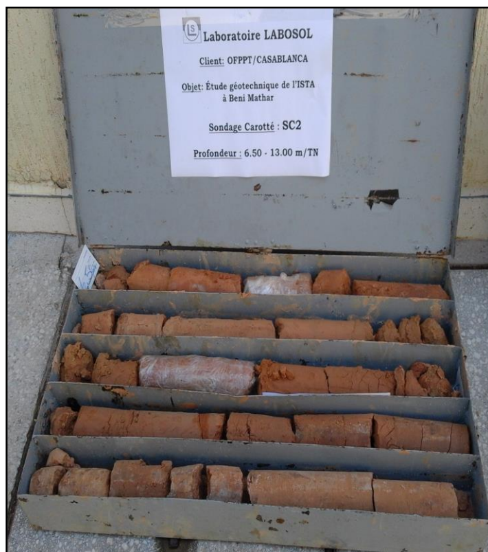
Photo N° 12 et 13 : Montrant les matériaux extrais du sondage carotté SC2
